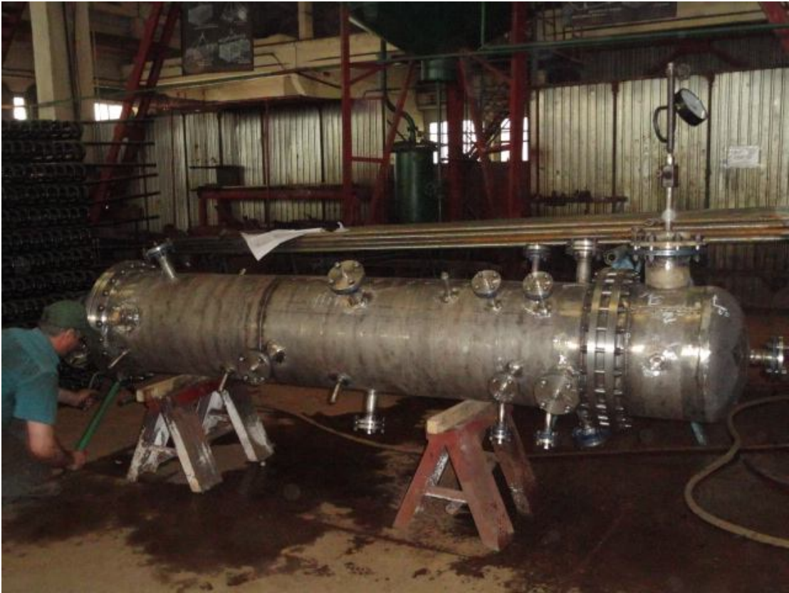
Реактор дослідної установки аерозольного нанокаталізу (випробовування на міцність після виготовлення)
