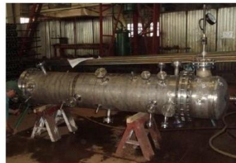
Реактор дослідної установки аерозольного нанокаталізу
