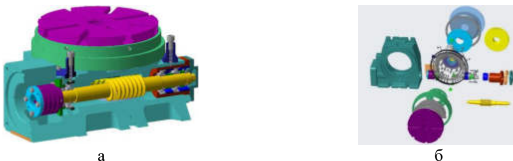
Рисунок. 3D-модель поворотного столу: а – поперечний розріз; б – рознесення
