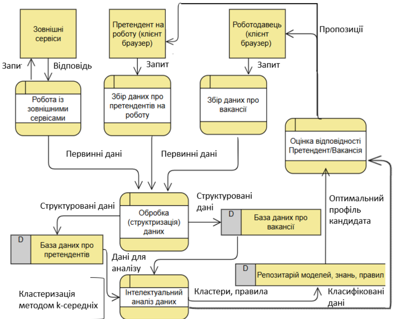
Рисунок 1 – Структурна модель вебсистеми підтримки рекрутингу в нотації DFD
