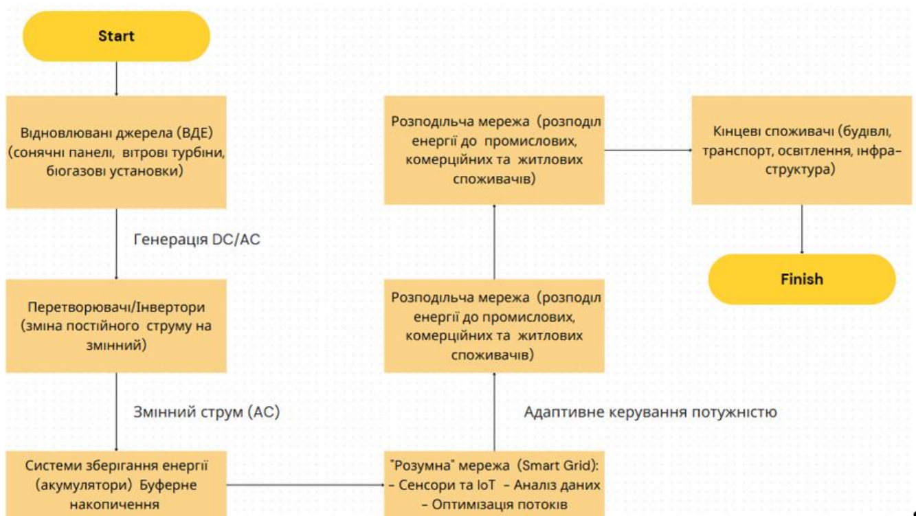
Рисунок 1 - Приклад наочної технічної блок-схеми інтеграції ВДЕ
