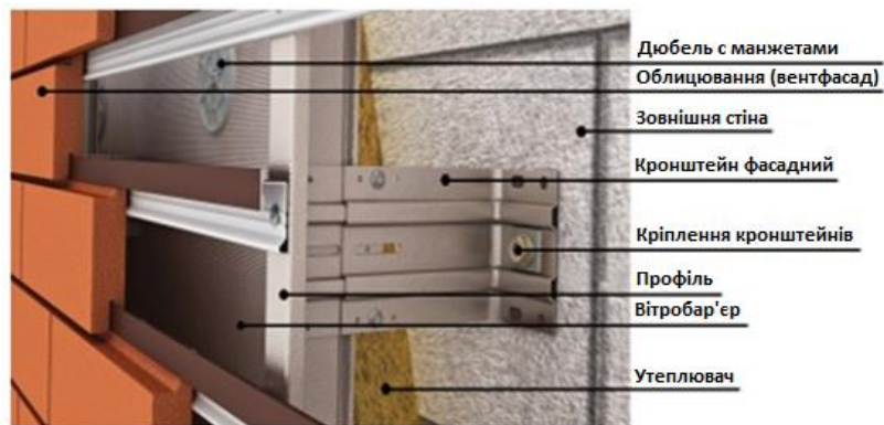
Рисунок 1. Схема кріплення вентилязованого фасаду до стіни
