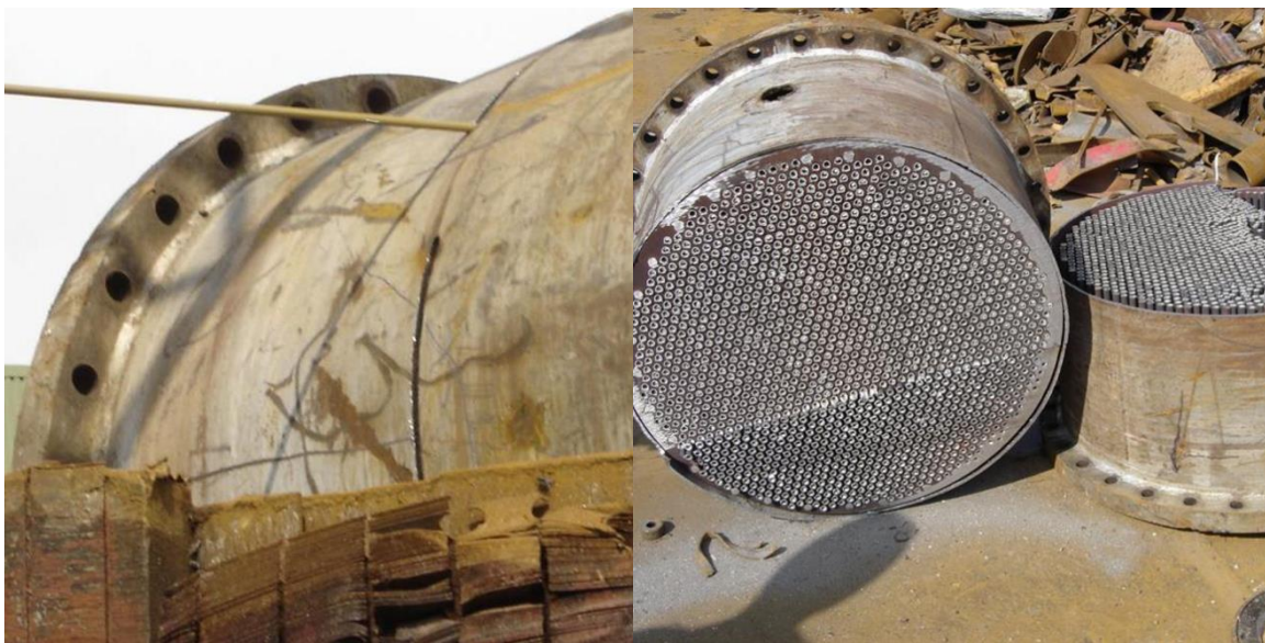
Рисунок 2. Різання металу алмазним канатом. Сухе різання. Теплообмінник. Матеріал CrNiSt
