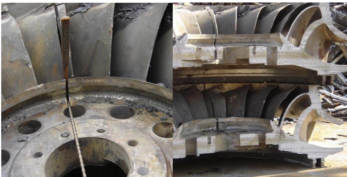
Рисунок 1. Різання металу алмазним канатом. Сухе різання. Турбіна Пелтона (ковшова). Матеріал – CrSt
