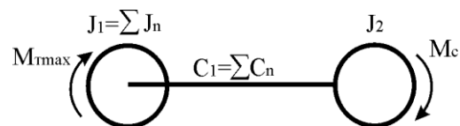
Рисунок 2. Двомасова однозв'язкова динамічна модель
