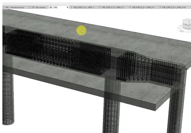
Рисунок 5. Результати армування балки складного перетину в Revit
