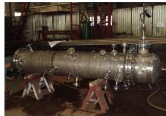
Реактор дослідної установки аерозольного нанокаталізу
