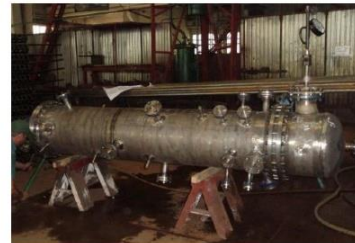
Реактор дослідної установки аерозольного нанокаталізу
