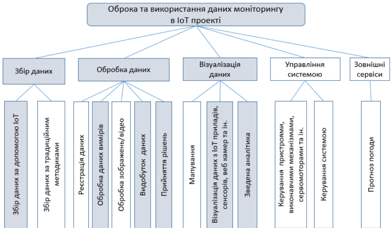
Рисунок 5.4 – Основні компоненти обробки даних моніторингу в IoT проекті
