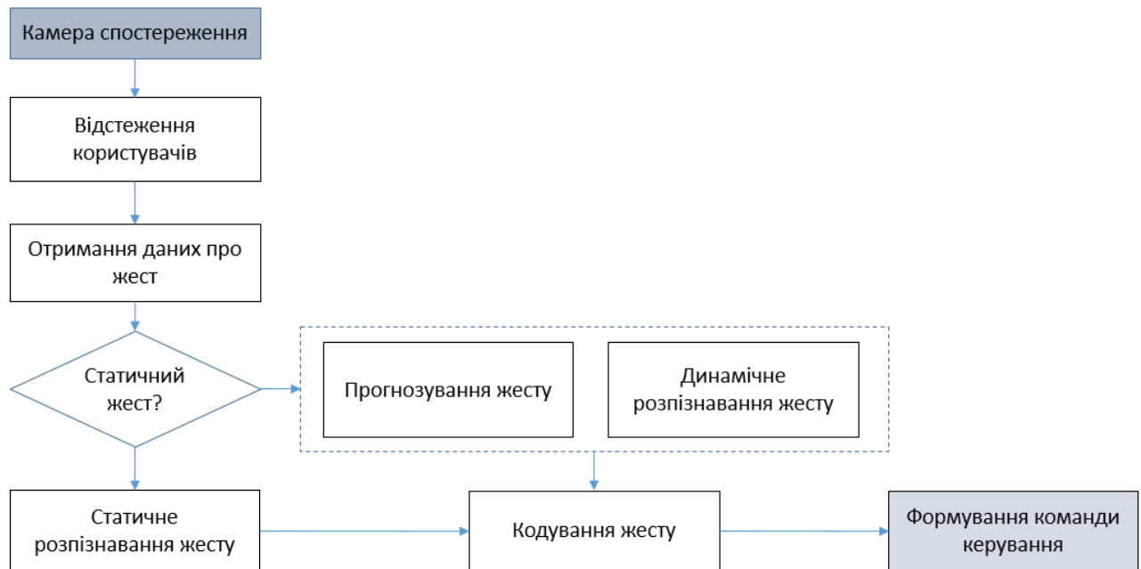
Рисунок 1.13 – Процес розпізнавання жестів в системі ЛМВ на основі зору (Адаптовано з [29, 88])
