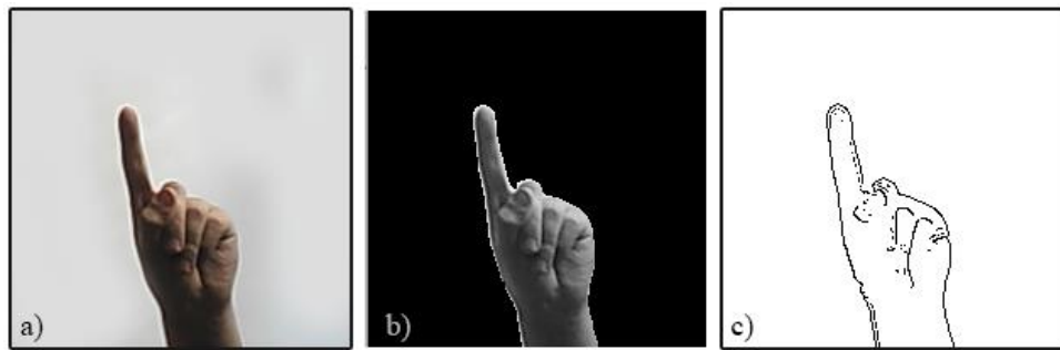
Рисунок 2.3 - Підготовка зображення для CNN: (а) початкове зображення, (б) сегментація за кольором шкіри, (с) виділення контурів за Canny
