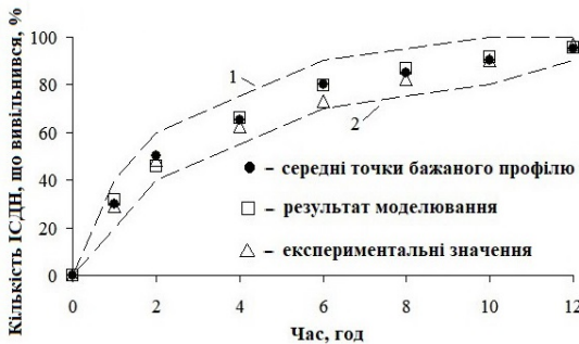
Рис. 2. Бажаний, розрахунковий та експериментальний профілі вивільнення ІСДН з таблеток, де 1,2 - верхня і нижня межі бажаного профілю
