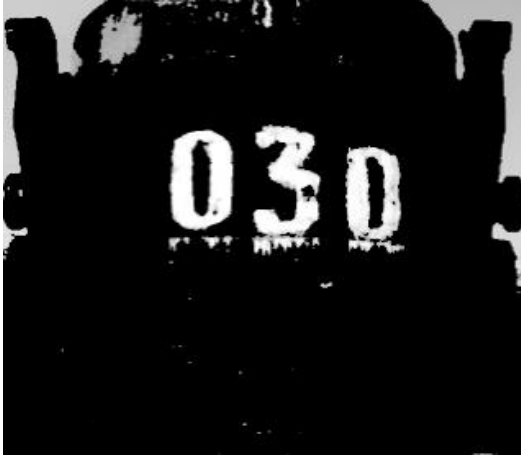
Рисунок 3 – Порогове перетворення вхідного зображення
