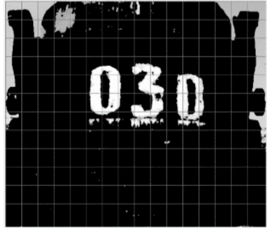
Рисунок 4 – Перетворення вхідного зображення – розбиття на сегменти
