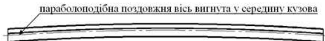
Рисунок 2.10 – Вид збоку на корисно попередньо деформовану балку хребтову концепта окатишевозу
