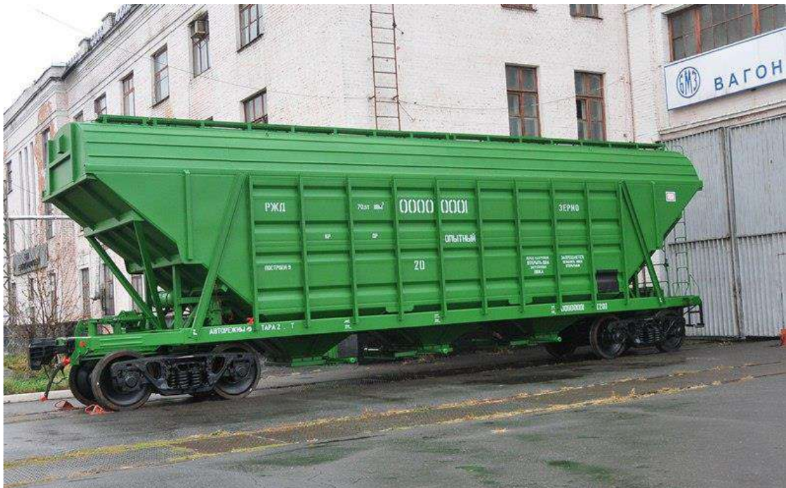
Рисунок 1.38 – Загальний вигляд вагона-хопера моделі 19-3058 для перевезення зерна
