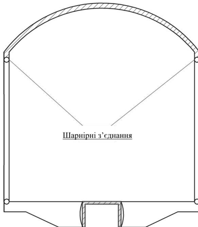
Рисунок 2.30 – Переріз мультифункціонального шарнірного концепту кузова універсального критого вагона
