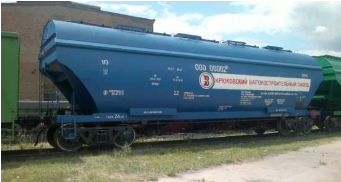
Рисунок 1.32 – Загальний вид вагона-хопера моделі 19-7053 для перевезення зерна
