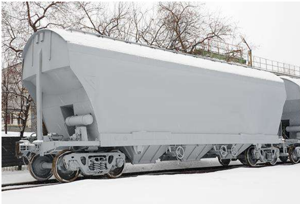
Рисунок 1.35 – Загальний вигляд вагона-хопера моделі 19-6870 для перевезення зерна
