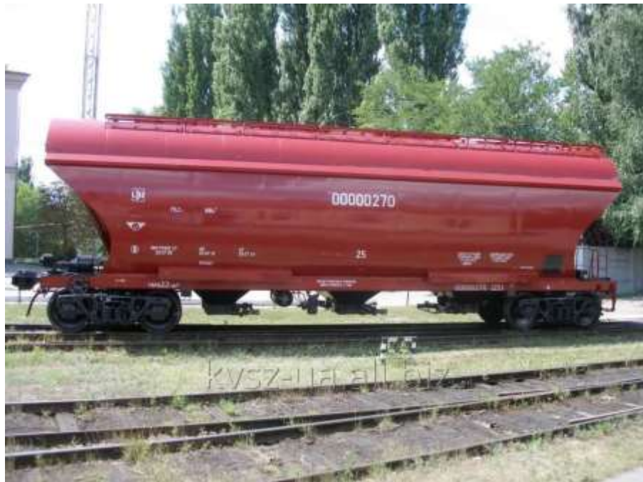
Рисунок 1.28 – Загальний вид вагона моделі 19-7016 для перевезення сипких вантажів
