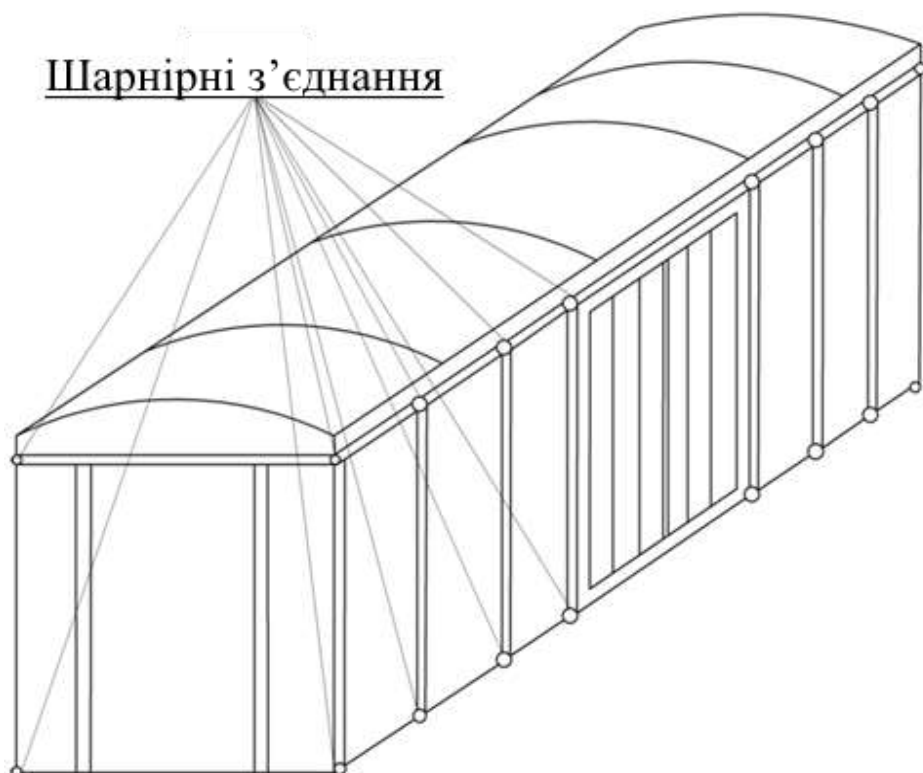
Рисунок 2.29 – Мультифункціональний шарнірний концепт кузова універсального критого вагона
