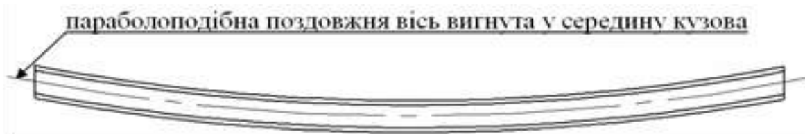
Рисунок 2.11 – Вид зверху на корисно попередньо деформовану стіну бокову концепта окатишевозу
