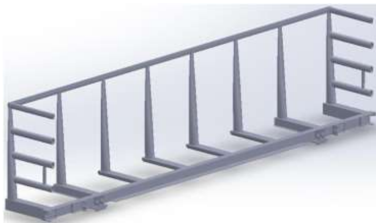
Рисунок 3.24 – Вигляд запропонованого multifunkціонального концепту напіввагону з розрізом посередині
