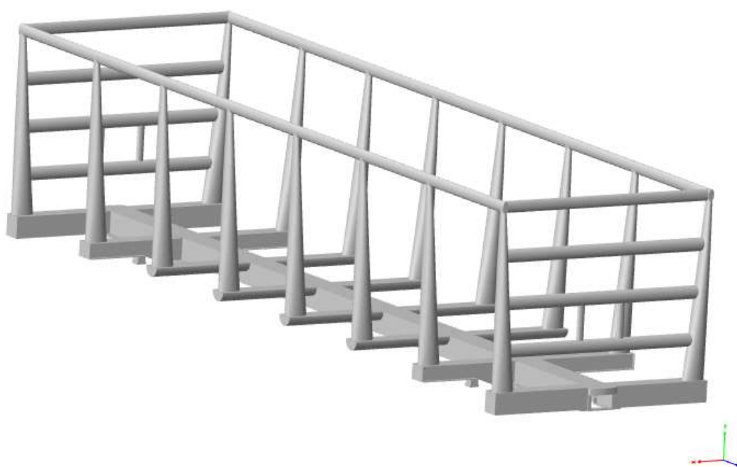
Рисунок 3.23 – Загальний вигляд запропонованого мультифункціонального концепту напіввагону, без урахування обшивки
