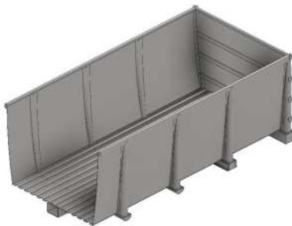
Рисунок 3.27 – Розріз запропонованого мультифункціонального концепту напіввагону посередині
