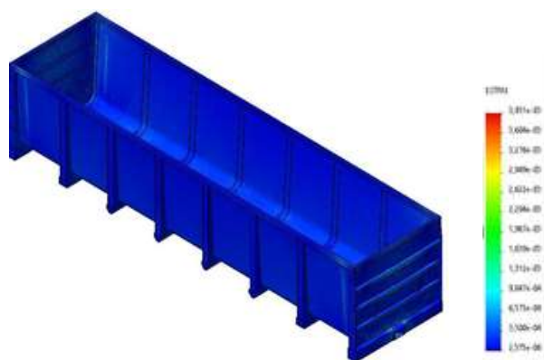
Рисунок 3.32 – Розподіл деформацій для першого розрахункового режиму запропонованого мультифункціонального концепту напіввагону (розтягнення)
