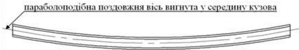
Рисунок 2.8 – Вид зверху на корисно попередньо деформовану стіну бокову концепта критого вагона-хопера для перевезення цементу
