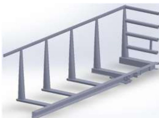
Рисунок 3.25 – Чверть кузова запропонованого multifunkціонального концепту напіввагону
