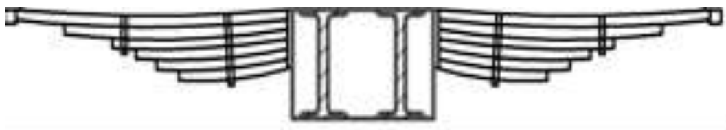
Рисунок 2.14 – Переріз концепту поперечних балок рами з листових ресор
