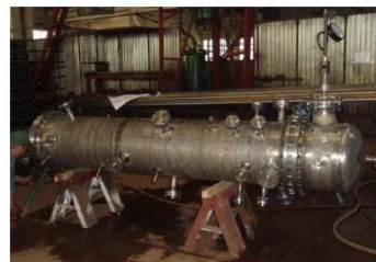
Реактор дослідної установки аерозольного нанокаталізу
