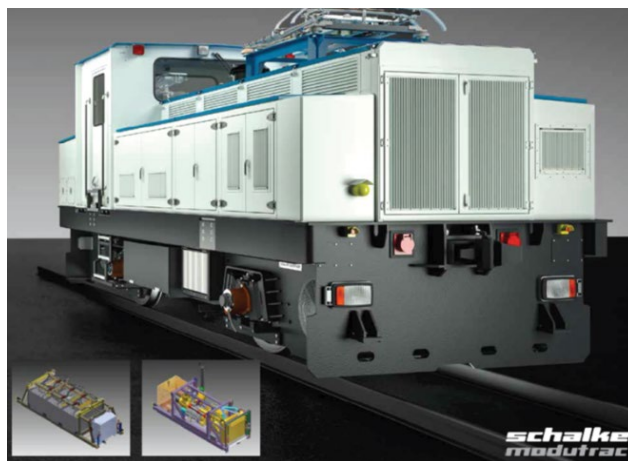
Рисунок 1 – Локомотив MMT-M-270-BDE ModuTrac від Schalke
