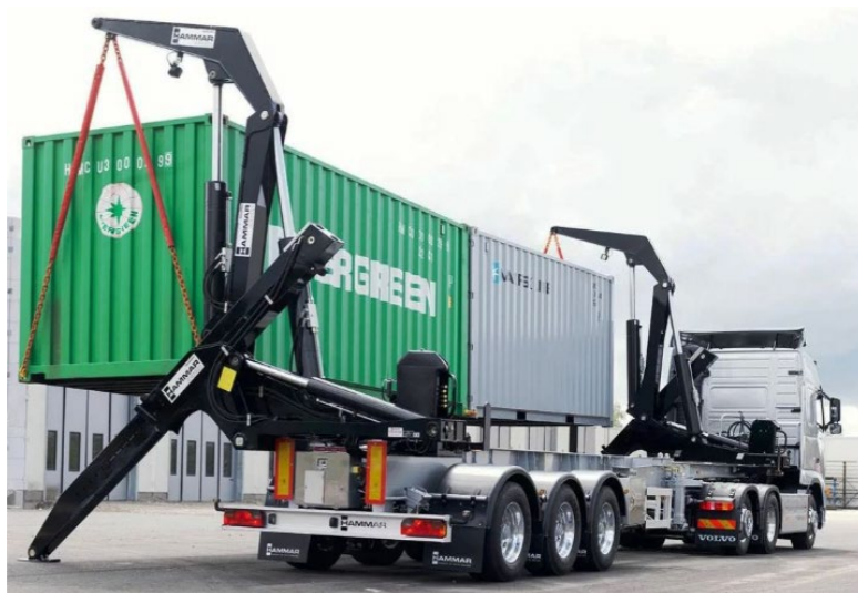
Рисунок 1 – Бічний навантажувач контейнерів в Sidelifter STEELBRO
