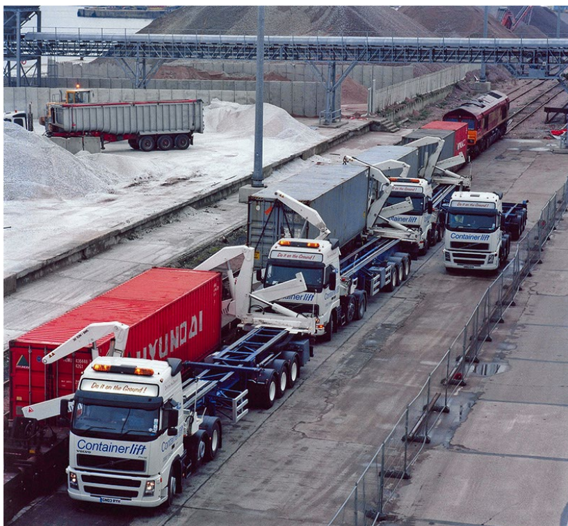
Рисунок 2 – Завантаження контейнерного поїзда за допомогою БНК
