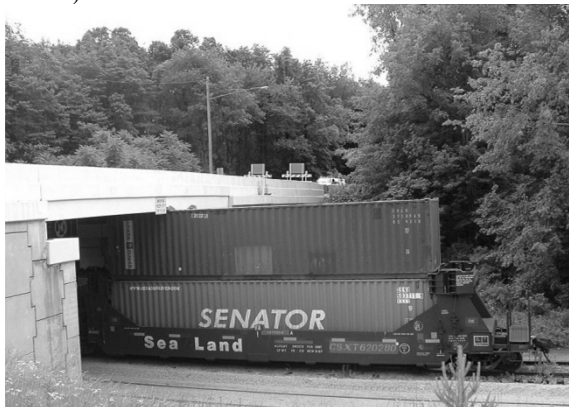
Рисунок 2 – Типовий приклад габаритних обмежень на залізницях
