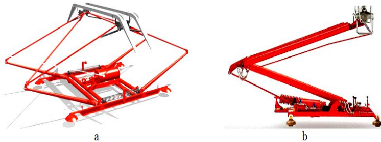
Рис. 2. Струмоприймачі пантографного типу: а – симетричні; б – асиметричні
