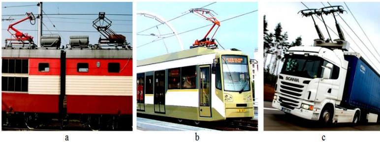
Рис. 1. Струмopриймачі різних типів рухомого складу а – електричні локомотиви; б – трамвайні вагони; в – автомобілі
